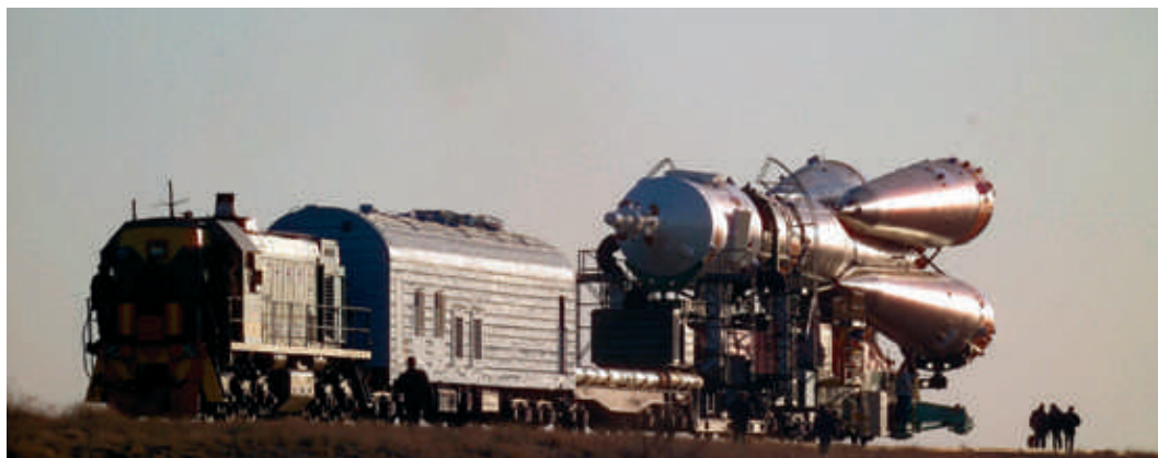
Un tren transporta el cohete hasta la plataforma de lanzamiento.
